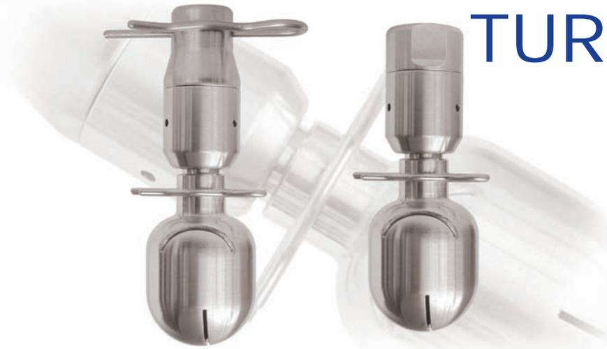
Der Turbo SSB 40 ist eine langsam drehende Rotationsdüse. Im Betrieb versetzt durchfließende Flüssigkeit den Kugelkopf in eine gleichmäßige gebremste Rotation. Dabei treten durch Schlitze flache Flüssigkeitsstrahlen mit hoher Reichweite aus. Die langsame Rotation der Düse begünstigt einen wirkungsvollen gebündelten Flüssigkeitsaufprall mit hohem Aufpralleffekt. Dadurch wird ein Reinigungseffekt bis zu 3 Meter Durchmesser erreicht.
