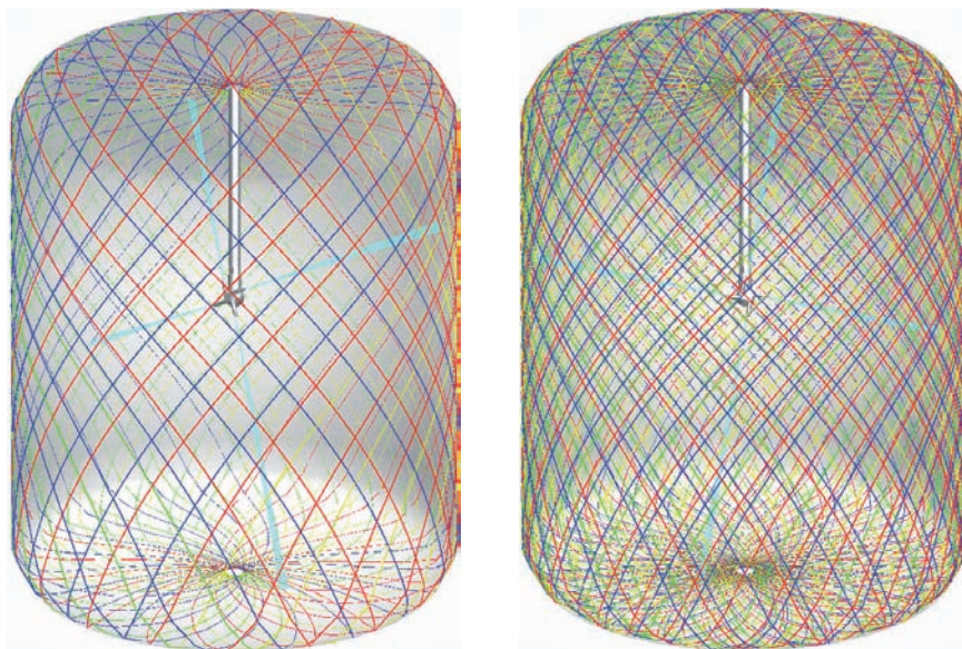
Reinigungsverhalten eines Tempest nach 2 und 5 Minuten
