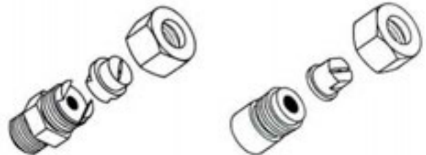
4. Düsenmundstücke mit und ohne Schwalbenschwanz Hochdruck (Kapitel 7)
