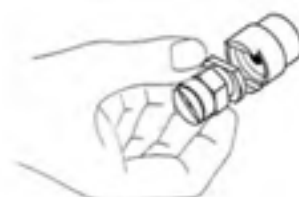
12. Bajonettssystem B max. 14 bar in Messing, max. 24 bar in Edelstahl (Seiten 8.9 bis 8.12)
