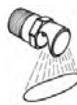
Type DZ umgelenkter Flachstrahl
