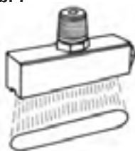
Type DL kraftvoller Flachstrahl (Mehrkanal)
