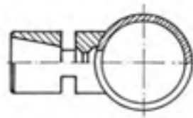
Type JM-M aus PVC zum direkten Aufkleben auf PVC-Rohre (speziell für Galvaniken), Abmessungen auf Anfrage
