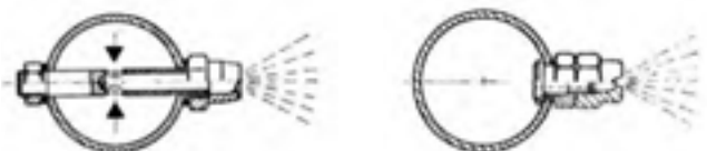
10. Hohlspindel-Düsen H für Rechteck- und Rundrohre, max. 10 bar Klemmring U für Rechteck und Rundrohre, max. 4 bar (Seite 8.13 und 8.14)
