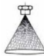
elliptische Aufprall- fläche Standard
