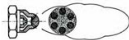
Innenmischung Breitwinkel Rundstrahl
