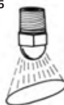
Type DF Flachstrahl
