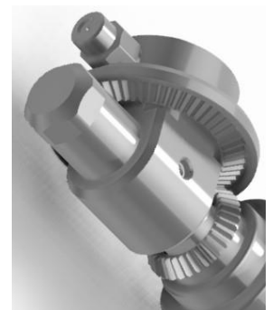
Abbildung 5.1 Offenliegendes Kegelgetriebe am Spritzkopf.
