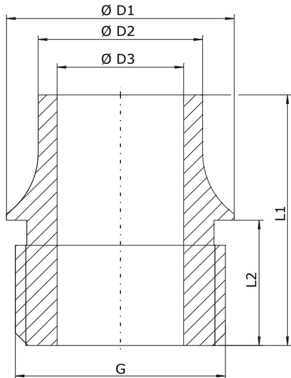
Geeignet für statische und rotierende Reiniger oder Reinigungsmaschinen. Metallisch dichtend. Werkstoff in Edelstahl 316L (1.4404). Auf Anfrage auch mit Zertifikat 3.1 oder PTFE Dichtung erhältlich.
