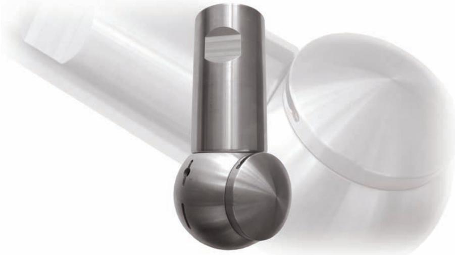
Der Torrent ist ein in seiner Arbeitsweise revolutionäres Reinigungsgerät, das baugleich den Geräten der Typhoon-Reihe ist. Anstelle von Vollstrahldüsen verfügt der Torrent über Schlitze und Bohrungen auf der Düsenplatte und dem Düsenkopf. Dadurch tritt die Flüssigkeit nicht in gebündelten sondern in flachen Strahlen aus. Das Reinigungsverhalten unterscheidet sich im Vergleich zu herkömmlichen Strahl- oder Orbitalreinigern.
